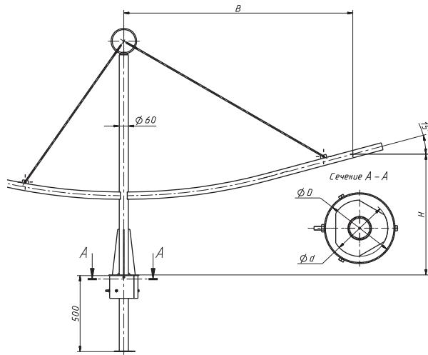
**Кронштейны серии 4 под два светильника односторонние на все типы опор**
