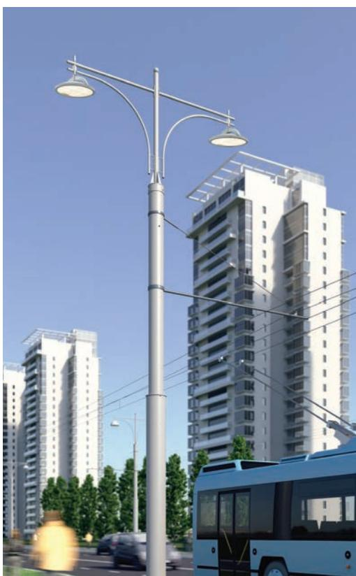
Опоры контактной сети выбираются по высоте, исходя из требований к выдерживаемой боковой нагрузке. Боковая нагрузка определяется при проектировании контактной линии электротранспорта в зависимости от типа и количества подвешиваемых проводов и климатических условий эксплуатации. Опоры данной серии рассчитаны на восприятие боковой нагрузки с отклонением верхней части опоры не более 1/70 ее высоты. Выбор кронштейнов осуществляется так же, как и в случае силовых опор.
