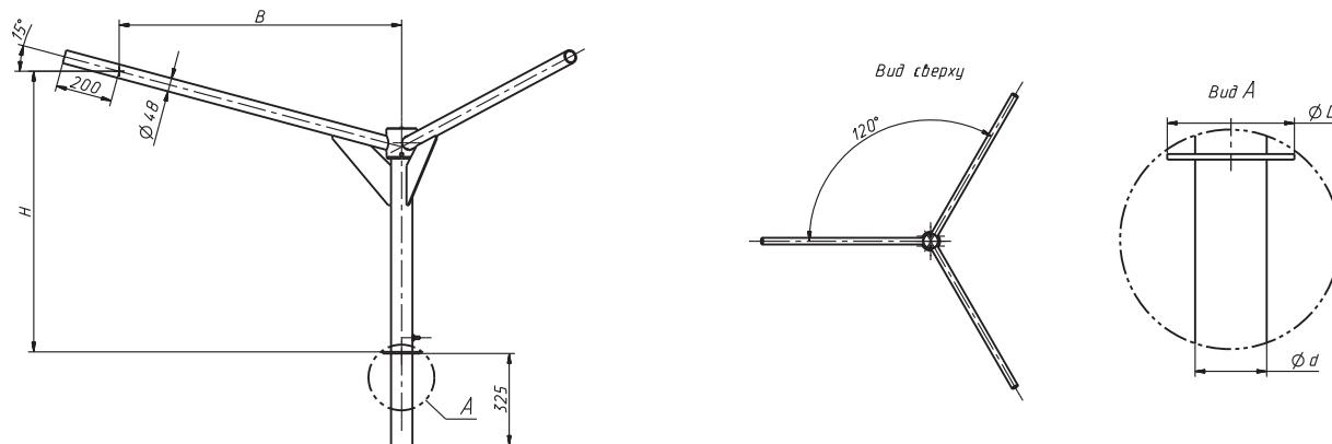
**Кронштейны серии 2 для четырех консольных светильников разнонаправленные на круглоконические и граненые опоры**
