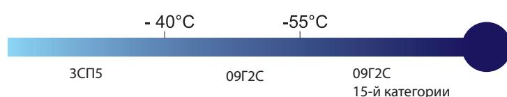
Сталь — использование различных типов стали в зависимости от климатических условий
